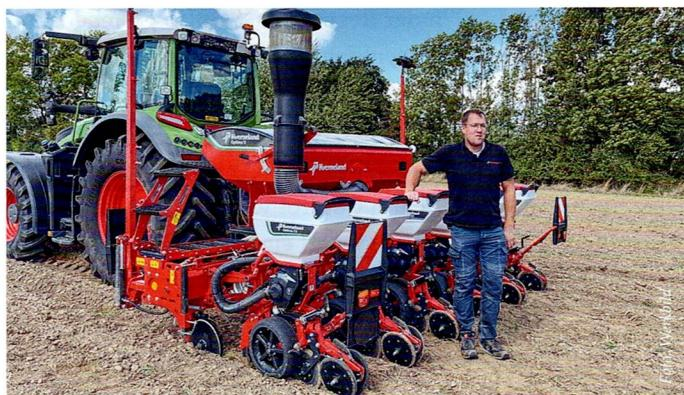
■ Das Geoforce-System von Kverneland übernimmt die automatische Steuerung der Reihenballastierung der Säeröhren und ist jetzt für alle SX-Maschinen verfügbar. Entwickelt für eine präzise Saatgutablage unter wechselnden Bodenbedingungen, passt Geoforce den Reihendruck automatisch in Echtzeit an. Jede Säeröhre wird individuell überwacht und während der Fahrt geregelt, sodass ein gleichmäßiger Auflagedruck der Säeröhre gewährleistet ist – für eine konstante Saattiefe, selbst in
