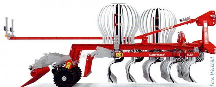
■ Mit dem Super Maxx 60-7 CultiSem präsentiert die Gütter GmbH eine neue Lösung, welche die bewährte Gütter-Technik mit einem integrierten Zinkensaat-system kombiniert. Das Zinkenschägergerät arbeitet mit einer 5-balkigen Zinkenanordnung und großem Durchgang. Die Saat wird mit einem Strichabstand von 13 cm direkt hinter den Federzinken im Windschatten abgelegt. Die Zinken sind mit schmalen Hartmetallscharen ausgerüstet, die bei minimalem Verschleiß eine konstante Saattiefe gewähr-
