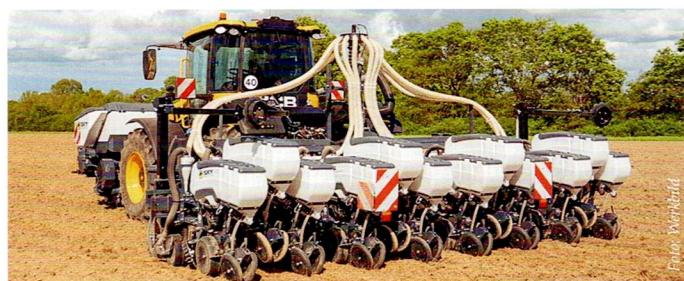
■ Mit der Sonic-Baureihe steigt SKY Agriculture in das Segment der Einzelkornsätechnik ein. Ausgestattet mit Technologie von Precision Planting soll die Sonic eine Ablagegenauigkeit von über 99 % ermöglichen, selbst bei Fahrgeschwindigkeiten von mehr als 12 km/h. Die optionale Andruckrolle ist – je nach Bedingungen (z. B. in feuchten Böden) – hochklappbar und bietet dadurch zusätzliche Einsatzflexibilität. Mit einem hydraulischen Schardruck von bis zu 350 kg pro
