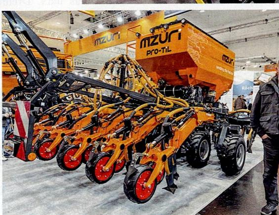
△ **Mzuri:** Die Pro-Til 4Tx ist eine Strip-Till-Sämaschine mit einem 5.400 l großen Saatguttank, der eine Aufteilung von 40/60 hat. Die Schare sind drehbar angelenkt, sodass Kurvenfahrten kein Problem sind. Der Schardruck lässt sich hydraulisch einstellen, die Arbeitstiefe über die Andruckrollen stellt hingegen ein Elektrolinearmotor ein. Sämtliche Schmierstellen sind über eine Zentralschmieranlage versorgt.
