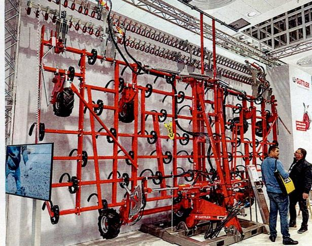
△ **Güttler:** Mit dem Super Maxx Heavy Duty erweitert Güttler sein Programm der Großfederzahngänge für Großtraktoren. Das Gerät gibt es in 6 und 7 m Arbeitsbreite. Die Arbeitstiefe lässt sich vollhydraulisch einstellen, eine Koppelstange verbindet dazu hinten und vorn die Räder miteinander.
