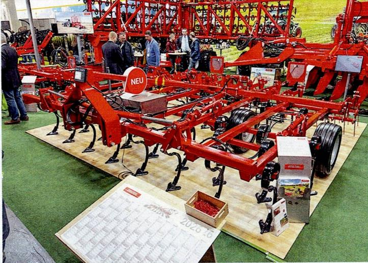
▷ **Agri Farm:** Agri Farm hat den Bio Eurocult III eControl mit einer elektrohydraulischen Arbeitstiefensteuerung ausgestattet. Dazu sind an den Rädern sowie am Nachlaufwerkzeug (Striegel oder Walzen) Sensoren montiert. Die Steuerung erfolgt über Isobus. Die Nachlaufwerkzeuge lassen sich mit einem Schnellwechselsystem tauschen.
