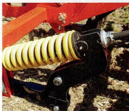
Die Zinken des Primus Plus können mit einer mechanischen Non-Stop-Überlastsicherung ausgestattet werden.
