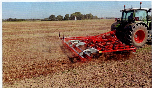
Der Güttler SuperMaxx BIO ist ideal für die Saattbettbereitung. Mit der 2. Zinkenreihe verbessert sich die Bearbeitungsqualität, die Unkrautbekämpfung und die Anpassung an die Bodenverhältnisse. Werkfoto
