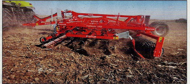
Der Gütler Feldmaster LK 60 erledigt fünf Arbeitsschritte in einer Überfahrt – Einebnen, Lockern, Lüften, Krümeln und Rückverfestigen.
