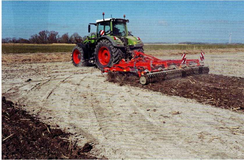
Die Güttler Großfederzahnegge SuperMaxx Culti mit Synthetik Ultra Prismenwalze beim Aufreißen schluffiger, verschlammter Böden nach dem Winter zum schnelleren Abtrocknen und zum Erwärmen der Böden. Hier unterstützt die Prismenwalze beim Zerkleinern, das Gerät ist trotzdem sehr leicht und kann mit hohem Tempo gefahren werden. Werkfoto
