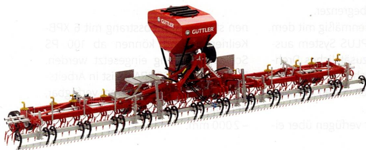
Güttler GreenMaster 800 Zinkensaat hat 8 m Arbeitsbreite. Gut zu erkennen das Ripperboard vorn und der Doppelstriegel mit 12 mm starken Federzinken sowie dem Saatgutbehälter. Werkfoto
