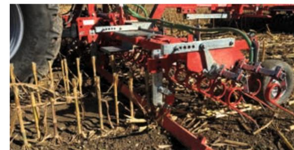
Die Planierschiene schlägt die Stoppeln an und drückt sie um
